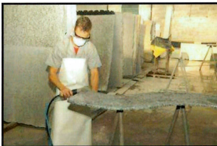
Figura 16 – Ferramenta com alimentação contínua de água
